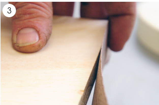
Der Tischler prüft, ob die Kante zum Seitenteil passt, bevor er die Kante maschinell anleimt.
