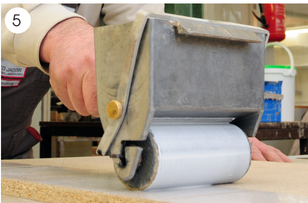
Von Hand wird der Klebstoff aufgetragen, mit dem die Furniere auf die Fronten geklebt werden.
