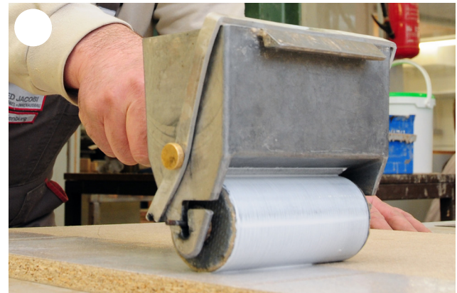
Von Hand wird der Klebstoff aufgetragen, mit dem die Furniere auf die Fronten geklebt werden.
