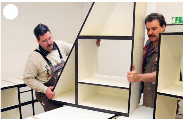
In der Tischlerei wird die Küche zur Kontrolle vormontiert, bevor sie beim Kunden eingebaut wird.
