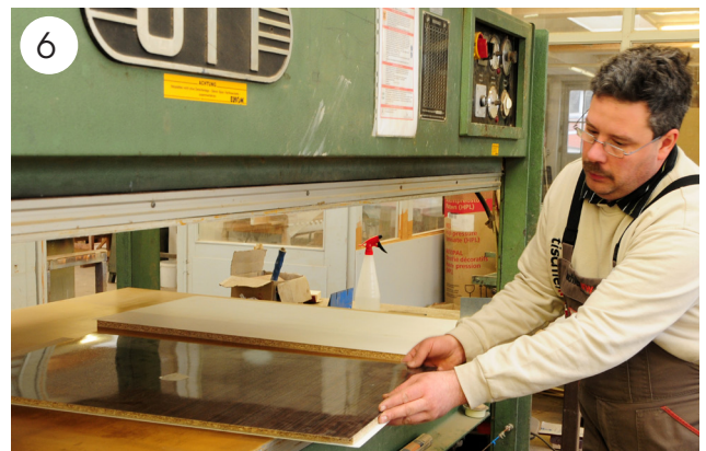
Die Furniere werden an der Presse unter Druck auf die Fronten geklebt.
