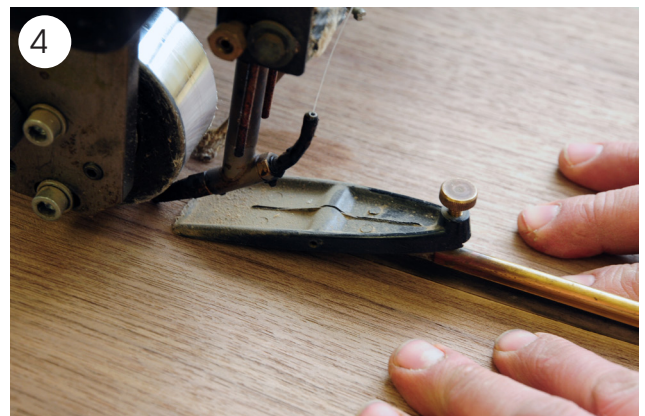
Zwei Furnierblätter werden mit einem Leimfaden zusammengefügt.
