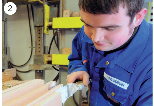
Der Geselle trägt Leim auf, der die einzelnen Teile des Fensterflügels später zusammenhält.
