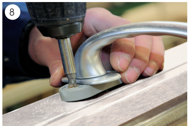
Zum Abschluss der Fensterproduktion in der Tischlerei werden die Scharniere und Griffe am Fenster montiert.
