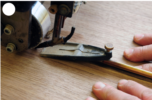
Zwei Furnierblätter werden mit einem Leimfaden zusammen gefügt.
