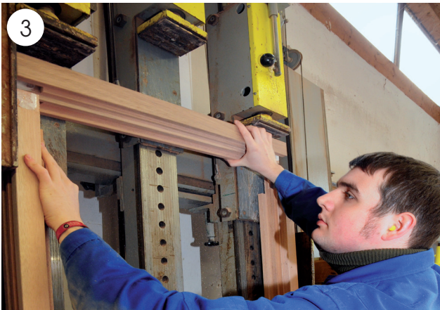
Die mit Leim bestrichenen Einzelteile des Fensterflügels werden an der Presse unter großem Druck zusammengefügt.
