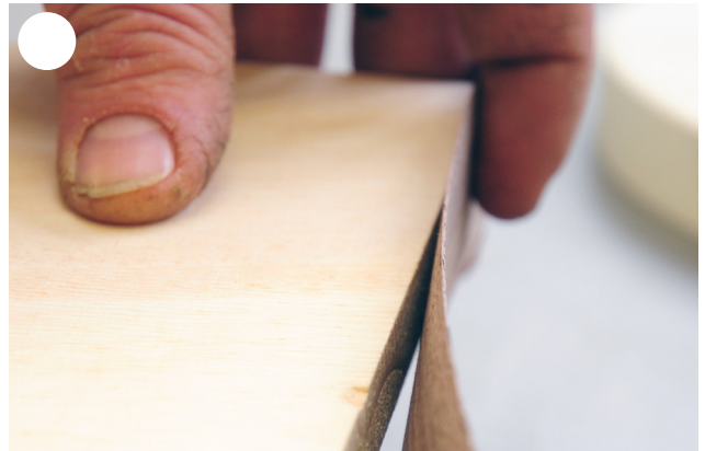
Der Tischler prüft, ob die Kante zum Seitenteil passt, bevor er die Kante maschinell anleimt.
