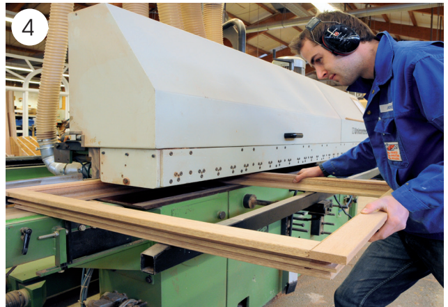
Am Umfälzautomat werden Unebenheiten im Profil des Fensterflügels geglättet.
