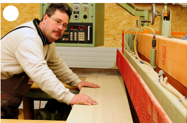
Aus Werkstoffplatten werden die Einzelteile der Küche zugeschnitten.
