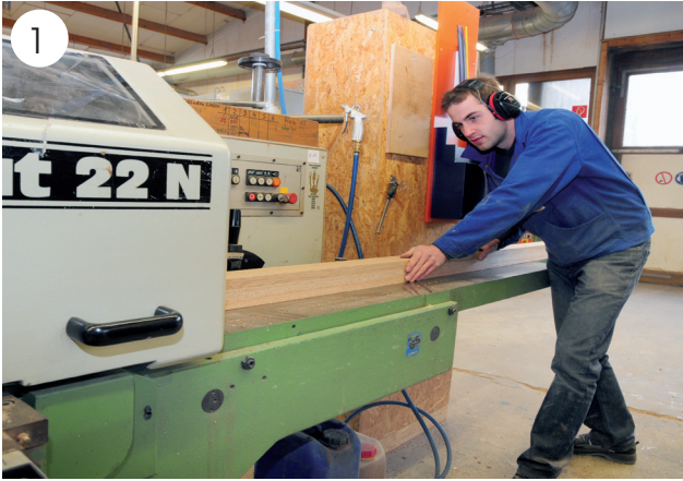
Mit dem Vierkanthobel werden die Profile aus Holz auf das richtige Format gebracht.
