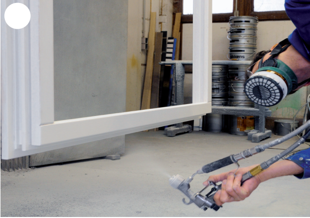
Beim Lackieren der Flügel- und Blendrahmen der Fenster muss der Geselle aus Gesundheitsgründen eine Atemschutzmaske tragen.
