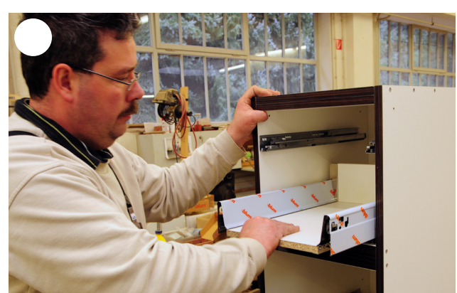
Nachdem der Tischler die Einzelteile zu einem Korpus verbunden hat, montiert er die Schubladen.
