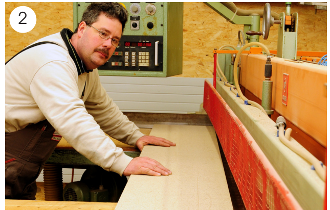
Aus Werkstoffplatten werden die Einzelteile der Küche zugeschnitten.
